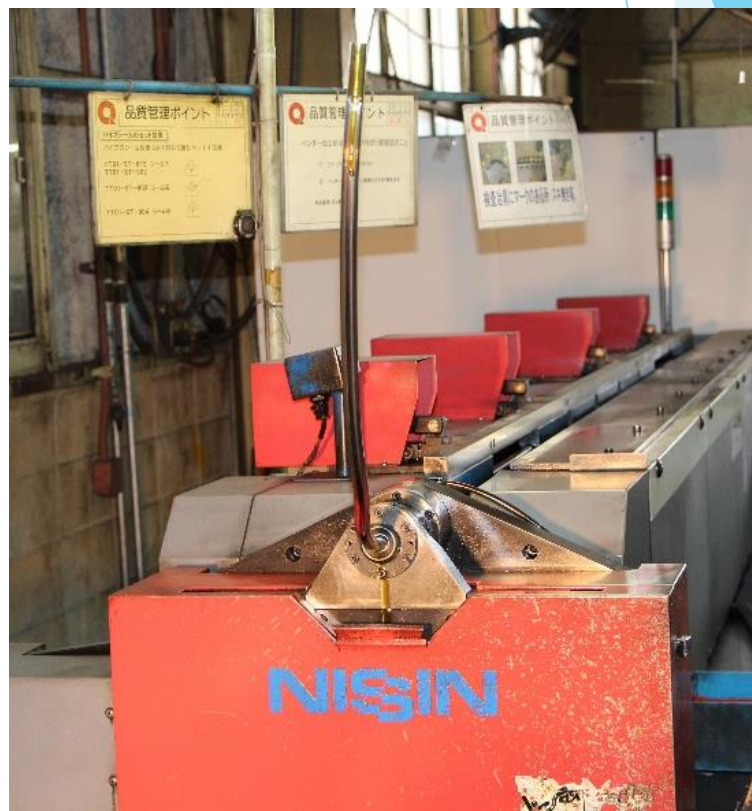
パイプフレーム曲げ (押し出しベンダー)
